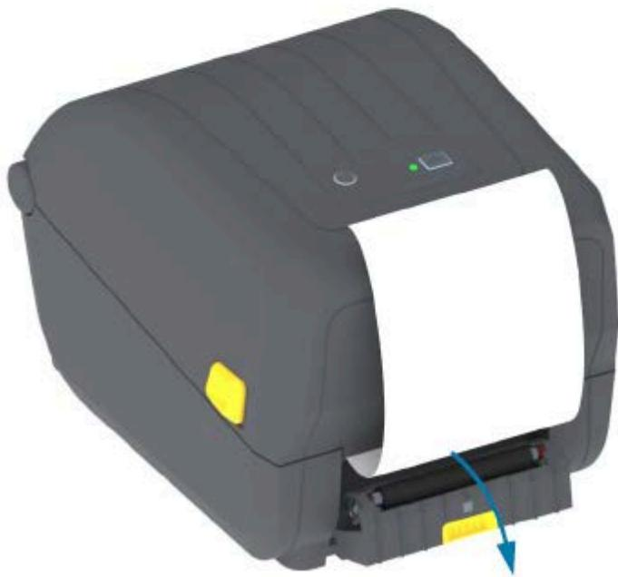
4. Вставьте подложку между дверцей отделителя и корпусом принтера.
