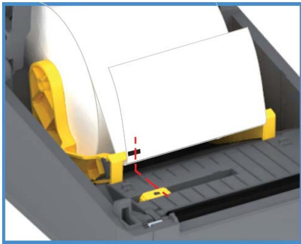
В процессе печати носитель может перемещаться из стороны в сторону в пределах  $\pm 1$  мм (по причине отклонений в составе носителя или повреждений краев при работе с ним). Также могут быть повреждены просечки на боковой стороне носителя.
