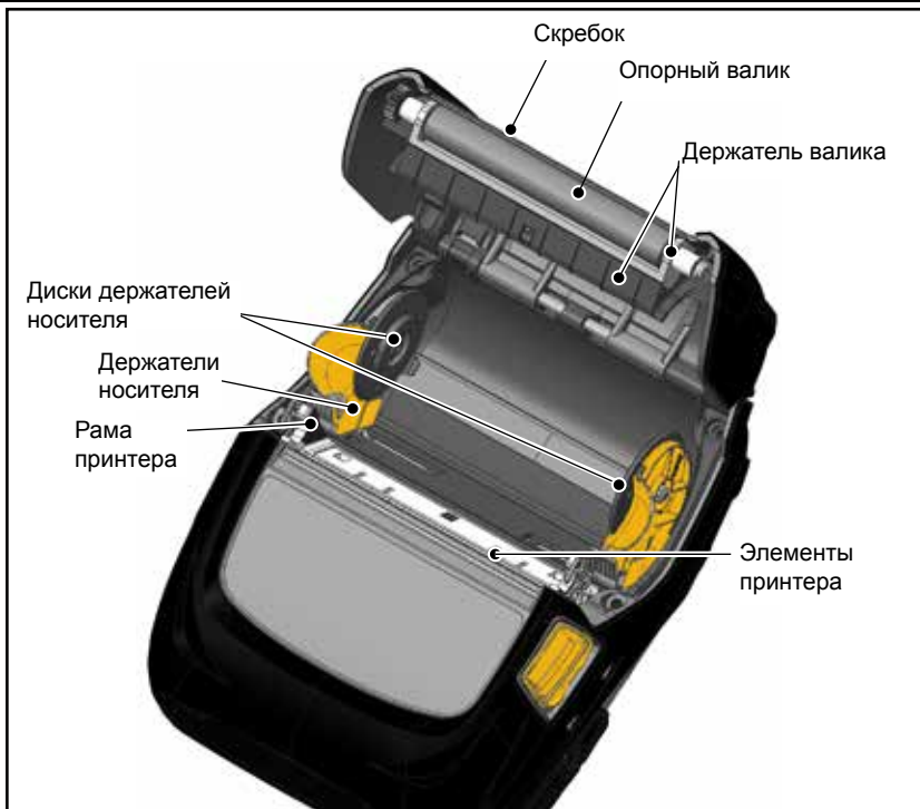
Рис. 20б. Очистка принтеров серии ZQ500 (носители без подложки)
