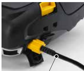
Рис. 10. Подключение к ПК кабелем
