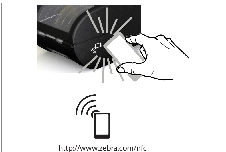
Рис. 31 • Сопряжение с помощью коммуникации ближнего поля (NFC)
