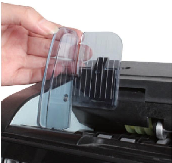
Малюнок 2-1 Встановлення направляючих банкнот
