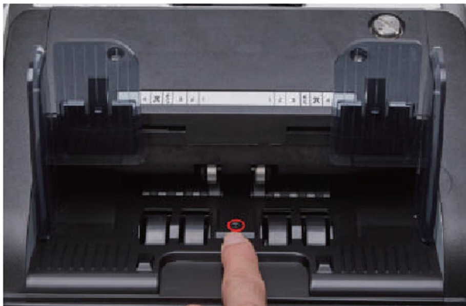
Малюнок 7-26 Закриття Датчика Бункера
