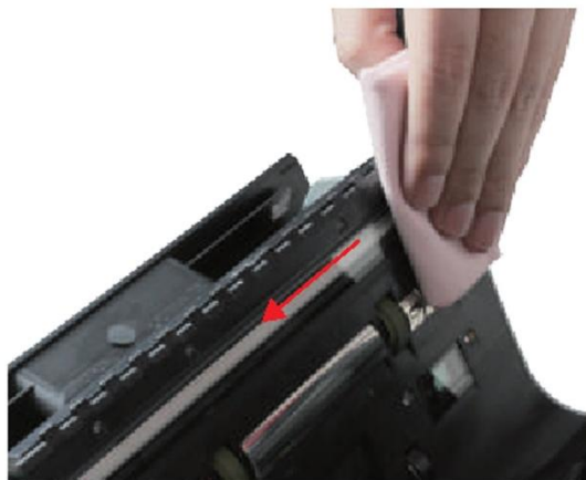
Малюнок 7-20 Очищення 2х КДЗ сенсорів
