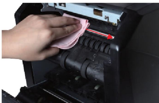
Малюнок 7-7 Очищення Верхнього Датчика КДЗ
