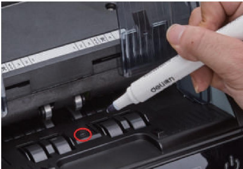
Малюнок 7-27 Використовуйте маркер, щоб зменшити чутливість датчика бункера
