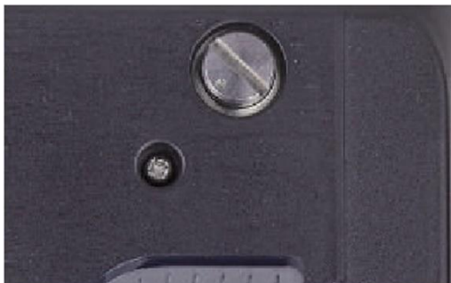
Малюнок 7-10 Гвинт Налаштування Щілини Подачі
