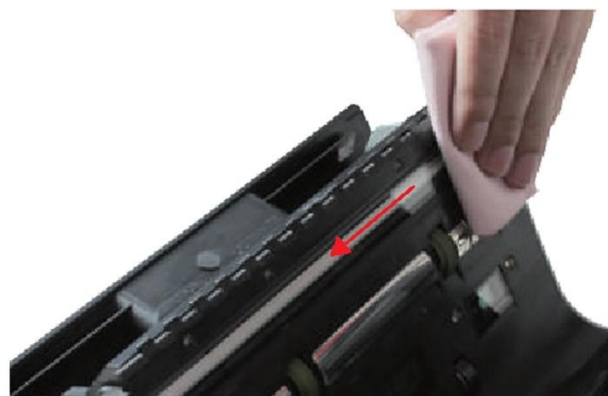
Малюнок 7-8 Очищення Нижнього Датчика КДЗ
