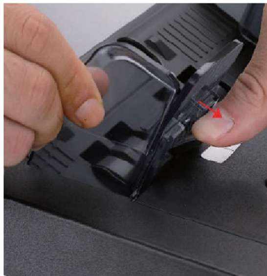
Малюнок 2-1 Встановлення направляючих банкнот
