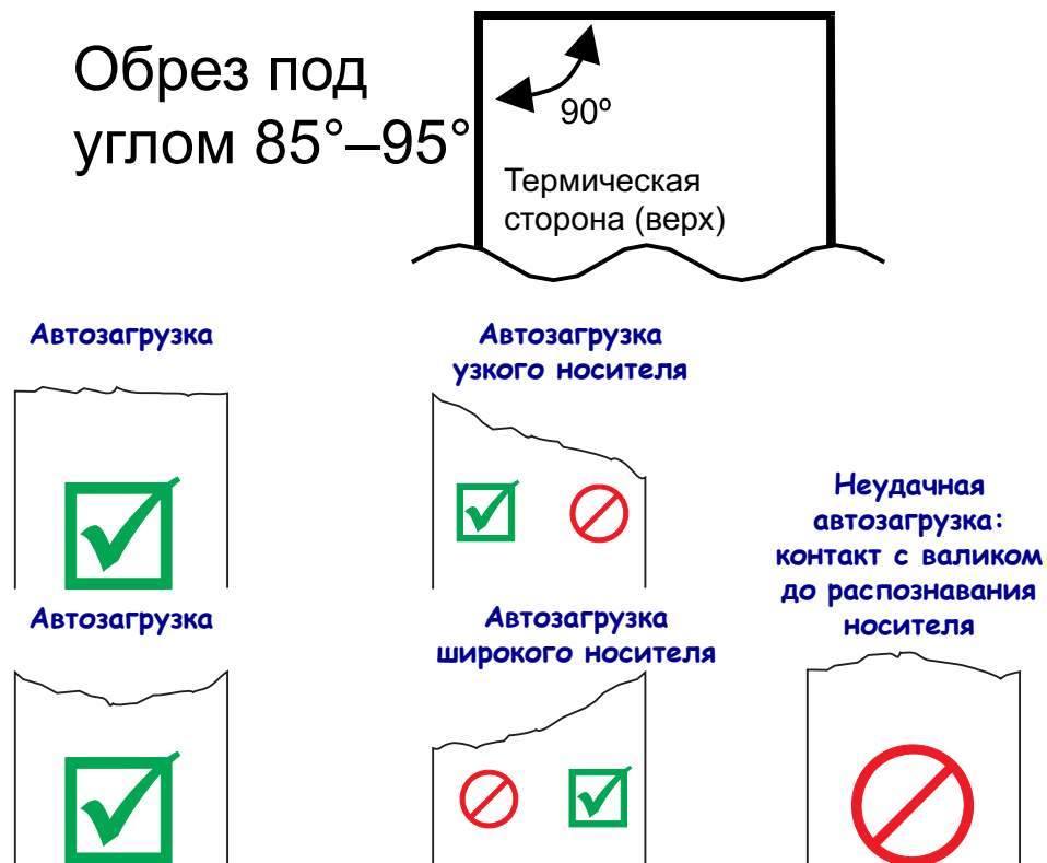
Рис. 1 • Кромка бумаги, подходящая для автозагрузки
