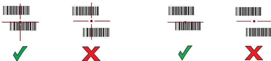
Рис. 28 Режим списка выбора в случае наличия нескольких штрихкодов в прицельной рамке: стандартный и расширенный диапазон
