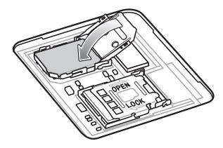
**6.** Чтобы зафиксировать, сдвиньте крышку держателя SIM-карты в соответствующее положение.
