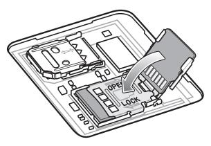
Чтобы зафиксировать, сдвиньте крышку держателя карты microSD в соответствующее положение (LOCK).
