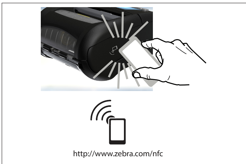
Рис. 27 • Сопряжение с помощью коммуникации ближнего поля (NFC)
