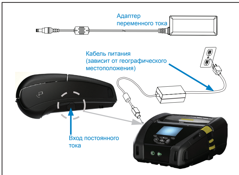
Рис. 3 • Зарядка с помощью адаптера питания от сети переменного тока
