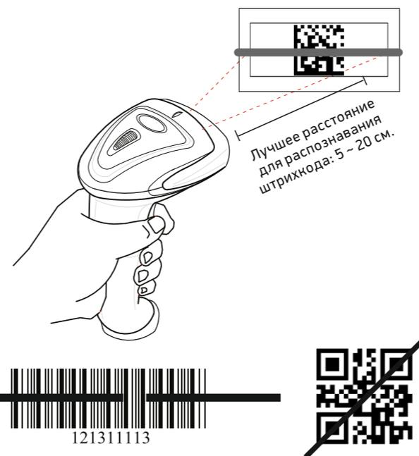
Луч подсветки должен быть помещен по центру штрихкода, при этом для лучшего считывания допускается отклонение сканера под углом +/-65° к вертикали.
