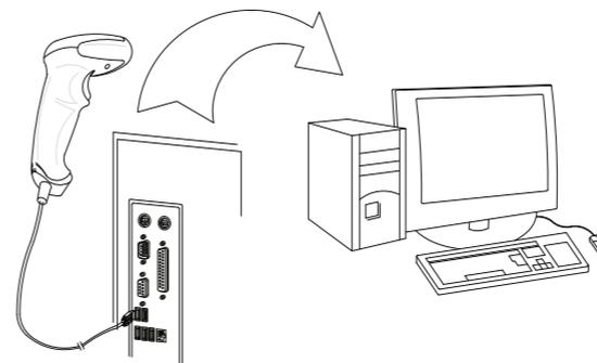
1. Подключите модульный разъем интерфейсного кабеля к порту кабельного интерфейса в нижней части рукоятки сканера.
